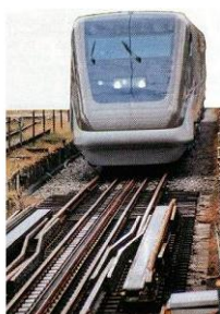
Změna rozchodu pomocí dvojrozchodných dvojkolí.
