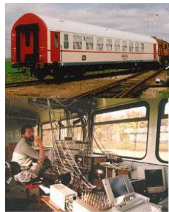
Měřicí vůz VŮZ Praha a aparatura měřicího vozu pro měření dynamických veličin.
