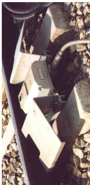
Snímač horkoběžnosti nápravových ložisek.
