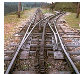
Příklad výhybky na ozubnicové trati s odbočením vpravo.
