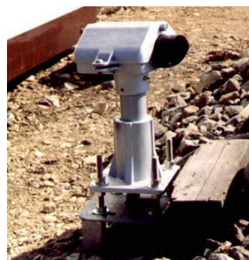
Snímač horkoběžnosti zdří, obruči a kotoučů kotoučových brzd.
