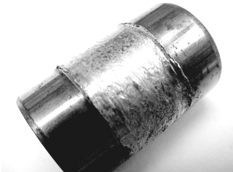
Obr. č. 4.4: Adhezivní opotřebenění pístního čepu
