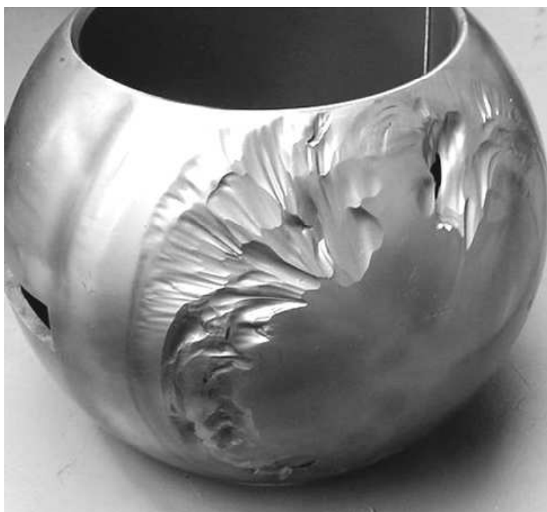
Obr. č. 4.6: Erozivní opotřebení koule uzávěru
