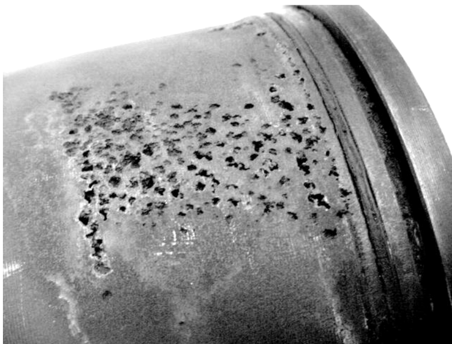
Obr. č. 4.7: Kavitační opořebení pouzdra válce spalovacího motoru
