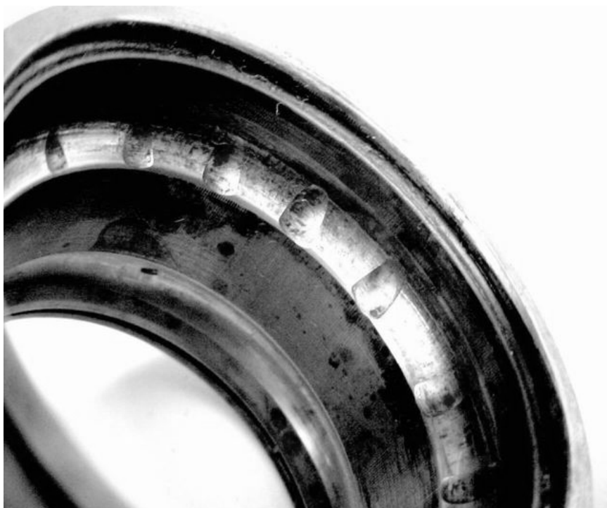
Obr. č. 4.9: Vibrační opotřebení valivého ložiska
