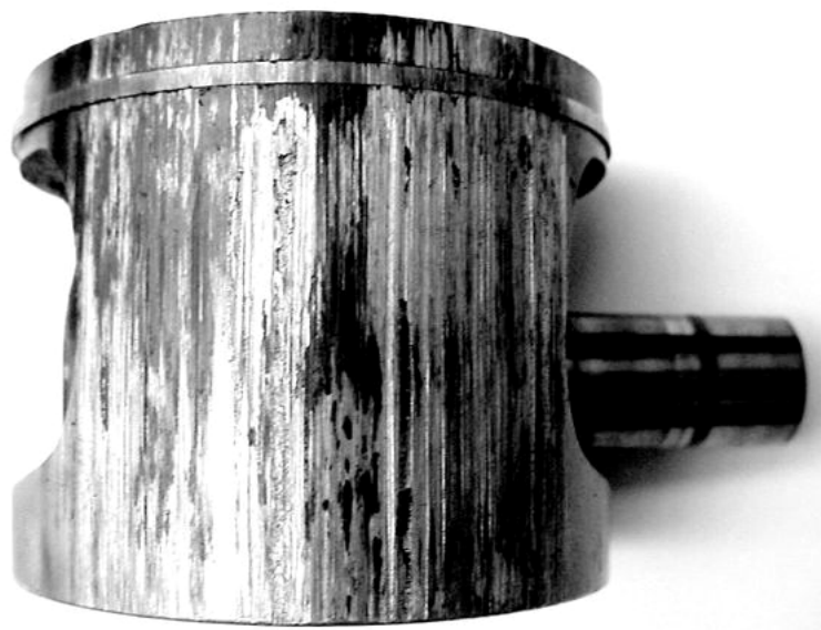
Obr. č. 4.5: Abrazivní opotřebení pístu spalovacího motoru
