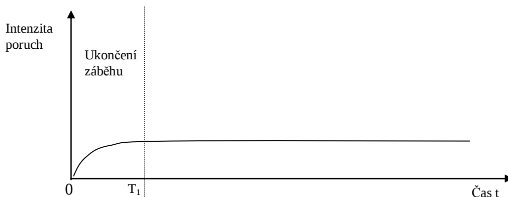
Obr. č. 1.6: Ilustrace průběhu intenzity poruch – ustálení po záběhové fázi
