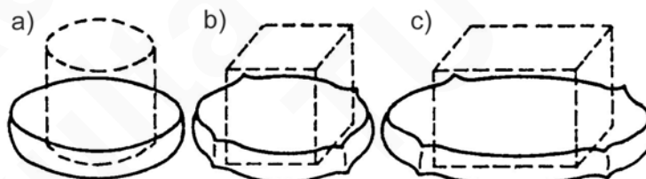
Obr. 2.2 Změna tvaru pěchovaných součástí (a – pěchování válce, b – pěchování krychle, c – pěchování hranolu)
