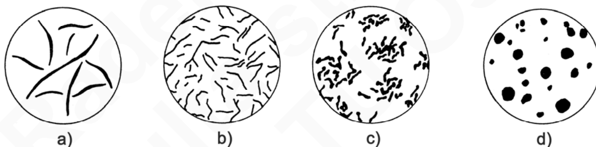
Obr. 8.8 Tvar grafitu v litinách (a – šedá litina, b – očkováná litina, c – temperovaná litina, d – tvárná litina)
