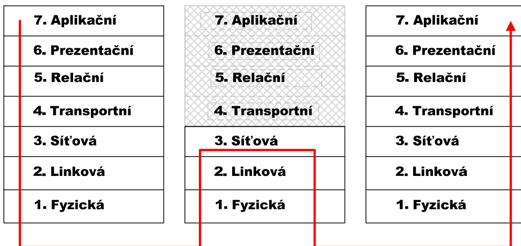
Obr. 10.6 Komunikace PC, router, PC podle OSI modelu
