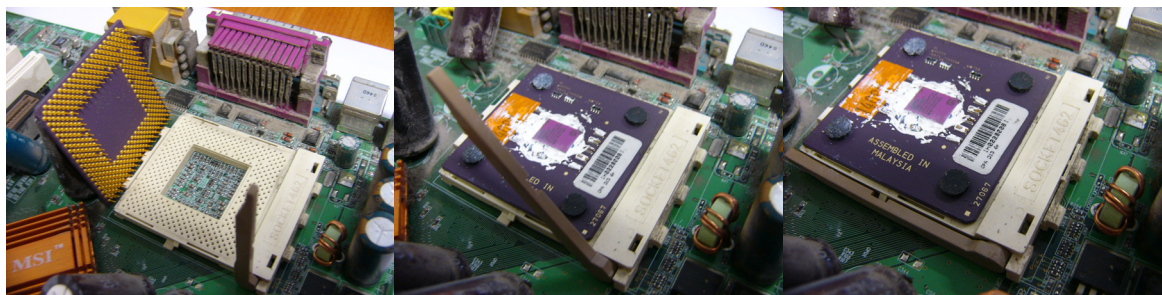
Obr. 4.5 Vložení procesoru do ZIF patice
