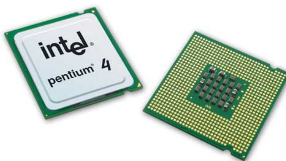
Obr. 6.10 Procesor Intel Pentium s měděnými ploškami místo pinů (LGA)
