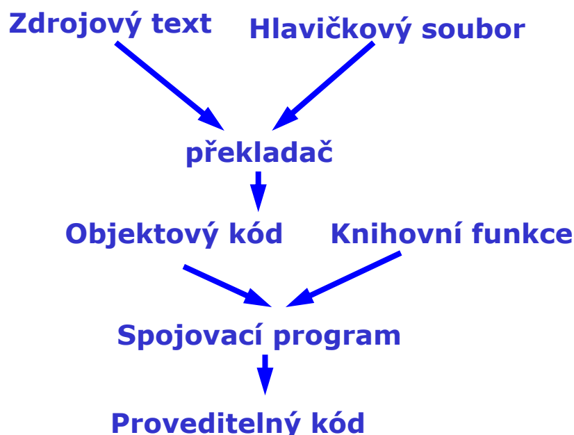
Obr. 4.1 Postup programu od vytvoření zdrojového kódu až po vytvoření exe souboru
