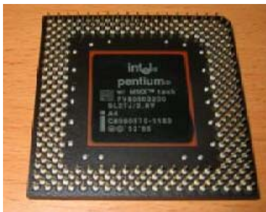
Obr. 1.3 Procesor Pentium pro patici Socket 7 má 321 vývodů
