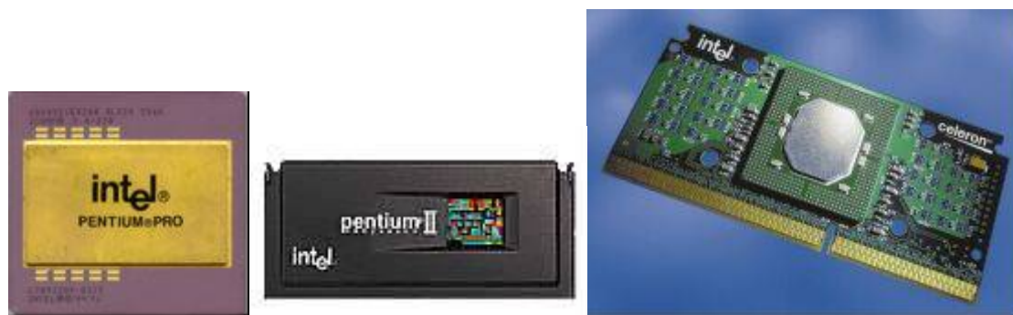
Obr. 7.3 Procesory šesté generace Intel Pentium Pro, Pentium II a Celeron ve verzi slot
