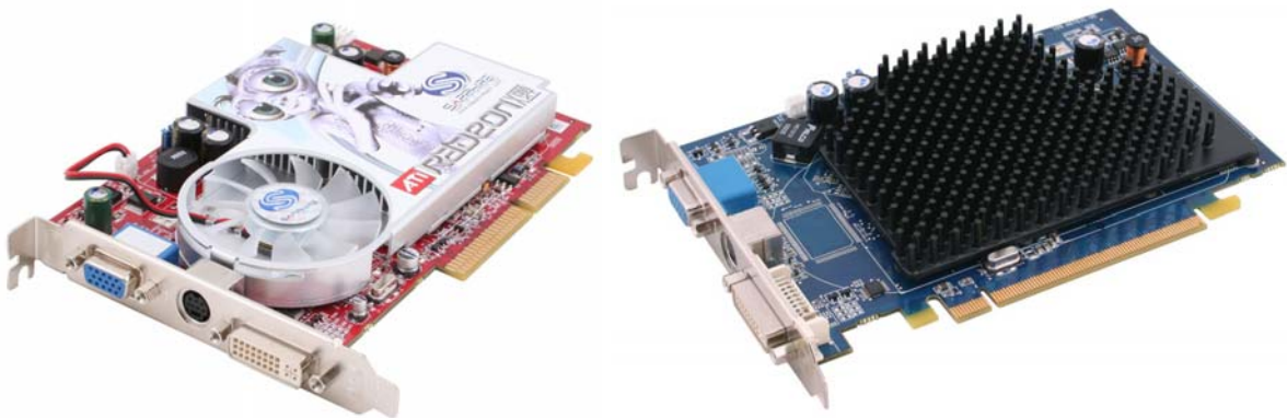
Obr. 12.1 Grafický akceleračtor s aktivním chlazením se sběrnici AGP 8x (vlevo), s pasivním chlazením se sběrnici PCI Express (vpravo)
