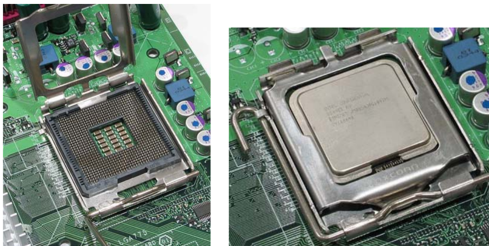
Obr. 1.5 Socket LGA775 současných (rok 2007) procesorů Intel
