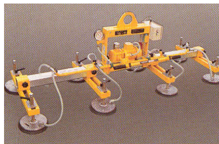
Obr. 4.1.3 – 12 Efektor s 9 přísavkami a společným ejektorem
