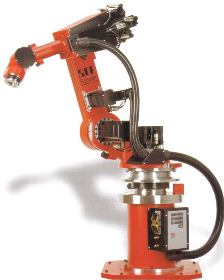
Obr. 5.1.2 – 10 Angulární robot s kabeláží vně konstrukce ramen
