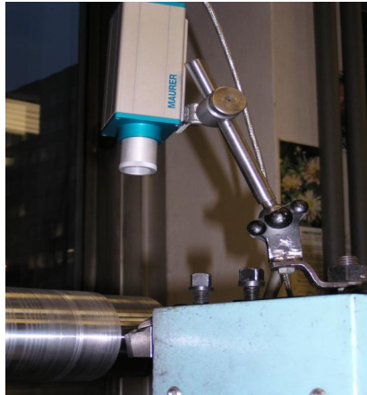
Obr.2.1.2 Experimentální měření teploty řezání pyrometrem
