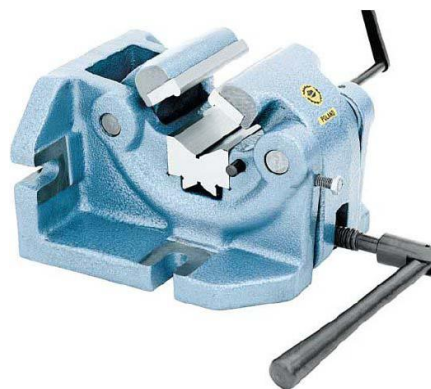
Obr. 1.2.51 Samostředící svěrák pro upínání válcových součástí
